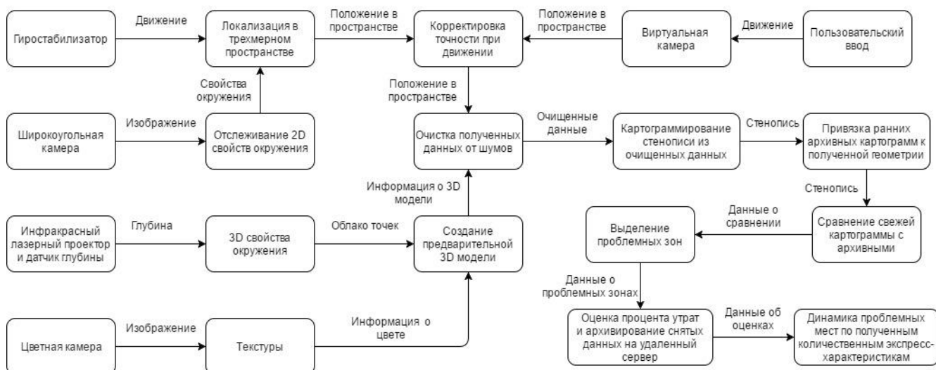
Рис. 2. Диаграмма работы модуля экспресс дефектоскопии стенописей
