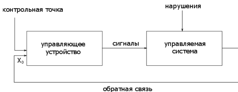
Рис. 1. Архитектура обучения с подкреплением с обратной связью
