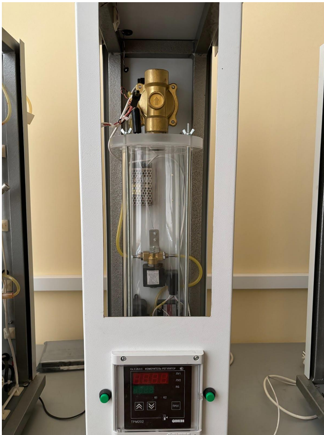
Рис. 5. Пример лабораторного стенда «Определение показателя адиабаты воздуха», подключенного к платформе.
