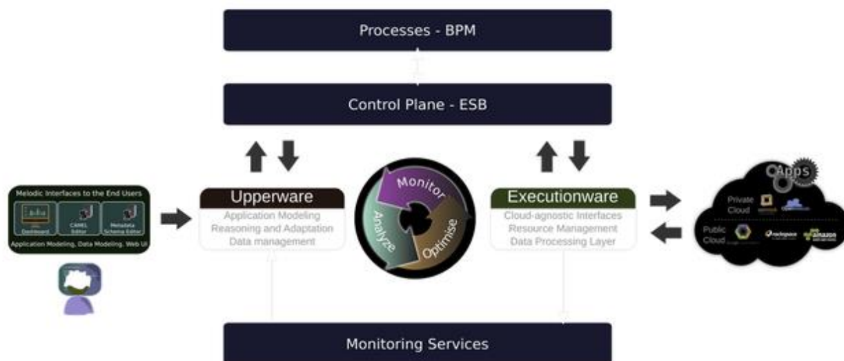
Рис. 3. Архитектура платформы Melodic. Источник: Complete set of documentation to start using multicloud and MELODIC. URL: https://melodic.cloud/guidebooks/
