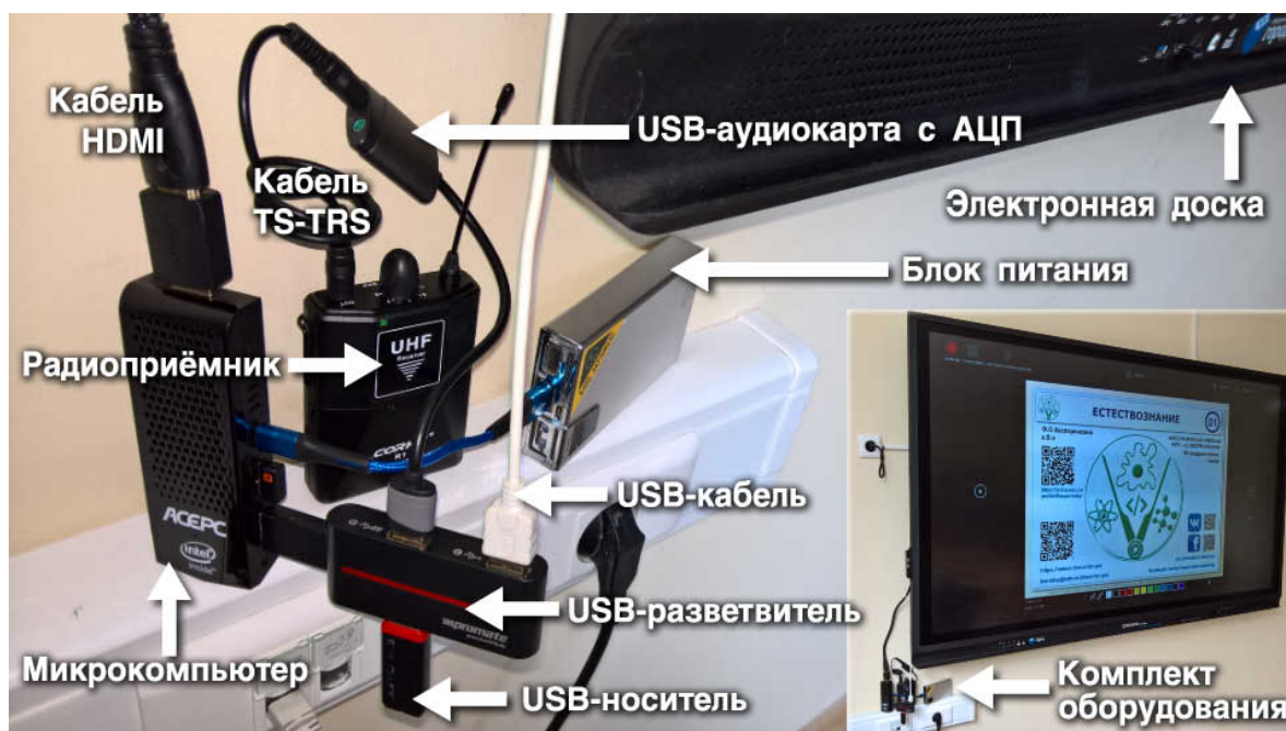
Рисунок 8. Подключение радиоприёмника, звуковой карты и USB-носителя данных к электронной доске
