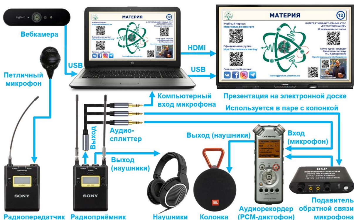
Рисунок 9. Схема подключения звукового оборудования для компьютерной записи видеолекций в аудитории
