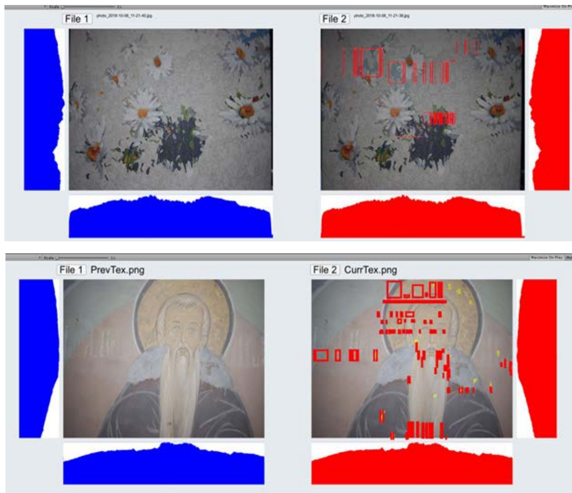
Рисунок 10. Дефектоскопия с декомпозицией
