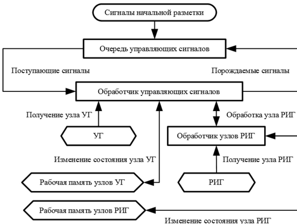
Рис. 2. Обобщённая структура событийного процессора
