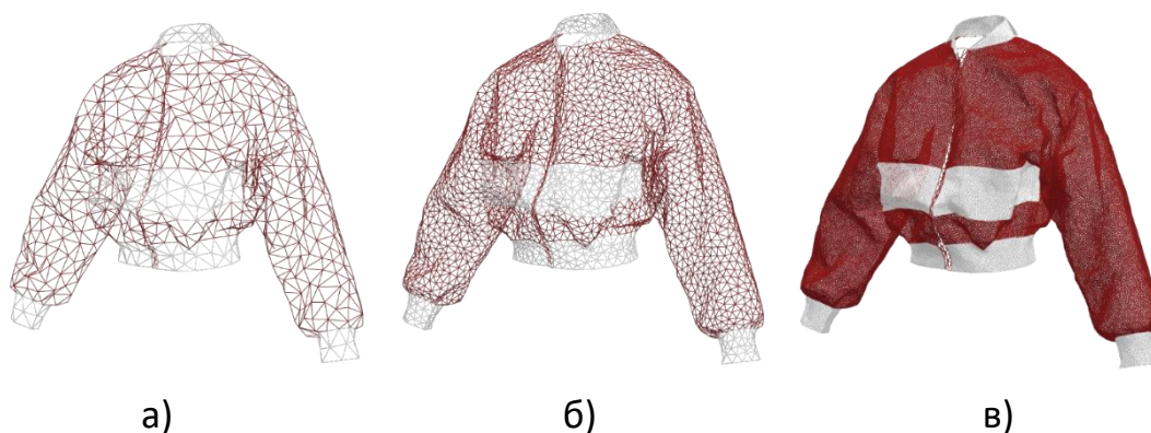
Рис. 6. Размер ячейки полигональной сети для цифровой модели одежды: а) 40 мм; б) 20 мм; в) 5 мм.
