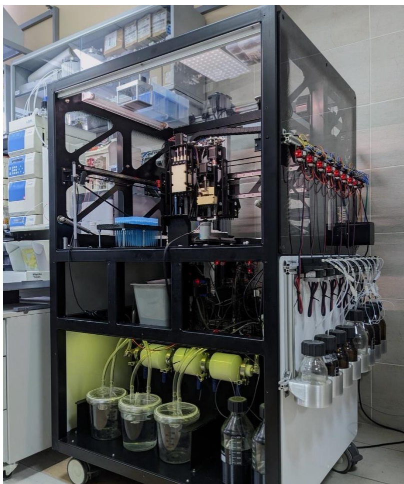
Рис. 1. Общий вид установки. По центру находится рабочее поле с манипулятором. Справа расположены хранилища растворителей с перистальтическими насосами. Слева на заднем плане виден хроматограф.
