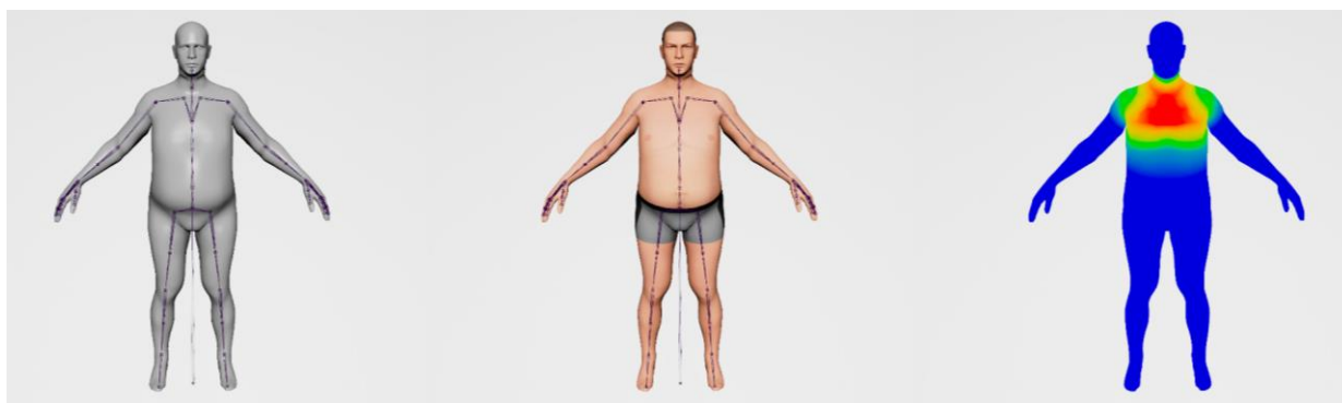
Рис. 13. Упрощенная трёхмерная модель должна иметь форму, идентичную исходной. На скелете должны быть удалены кости без анимации и деформирующие мелкие участки (лицевые мышцы и т. д.). Веса должны быть скопированы с исходной модели
