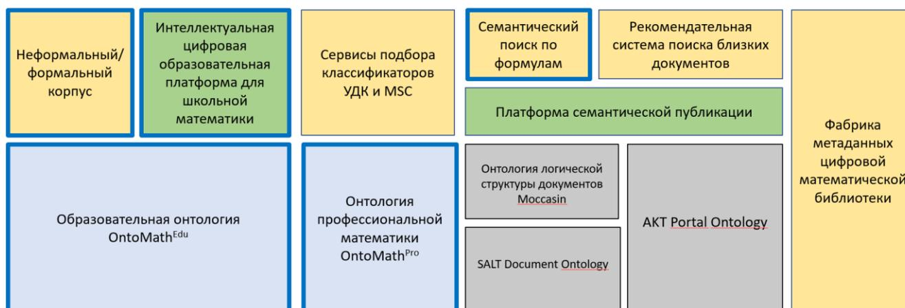
Рис. 1. Архитектура цифровой экосистемы OntoMath. Компоненты экосистемы распределены по уровням – компоненты, расположенные уровнем выше, используют функционал нижележащих компонент. Отдельный блок образуют компоненты экосистемы (выделены утолщенной внешней границей), предназначенные для образовательных целей
