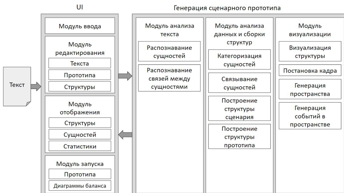
Рис. 3. Схема инструмента генерации сценарного прототип
