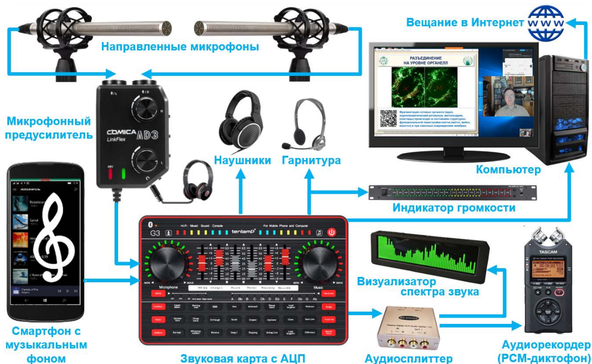
Рисунок 15. Схема подключения звукового оборудования для онлайн-преподавания
