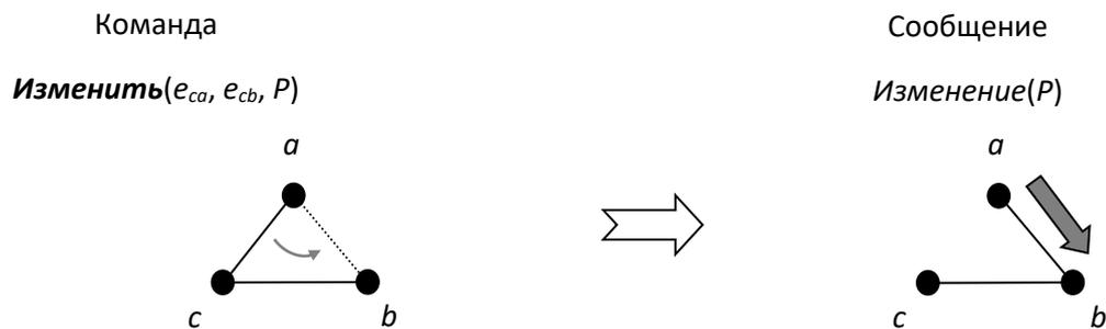
Рис. 1. Трансформация  $a \rightarrow c \rightarrow b$ : замена ребра  $ac$  на ребро  $ab$
