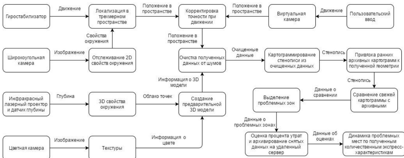
Рис. 2. Диаграмма работы модуля экспресс дефектоскопии стенописей
