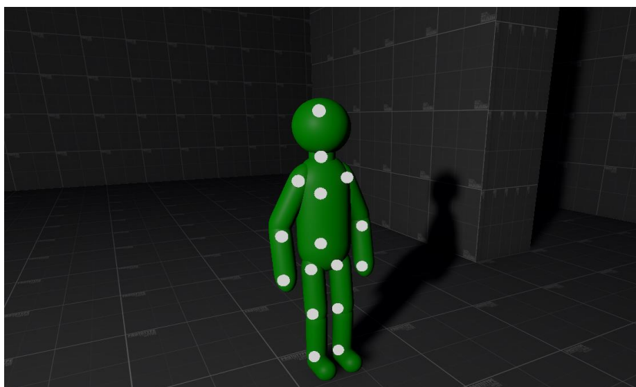
Рис. 4. Расставленные на модели точки проверки линий видимости.
