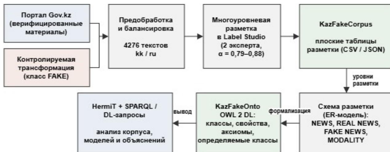
Рис. 1. Схема исследования: от сбора данных к онтологической модели и запросному слою.
